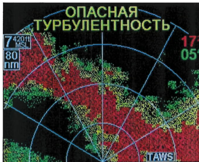
Рисунок 9 - Предупреждение от РЛС, работающей в дежурном режиме, об обнаружении опасной турбулентности (при отображении информации от TAWS)
