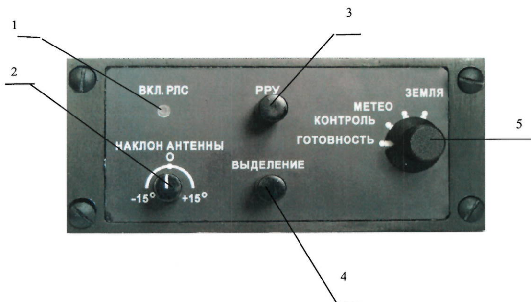
Рисунок 2 - Органы управления пульта управления РЛС
