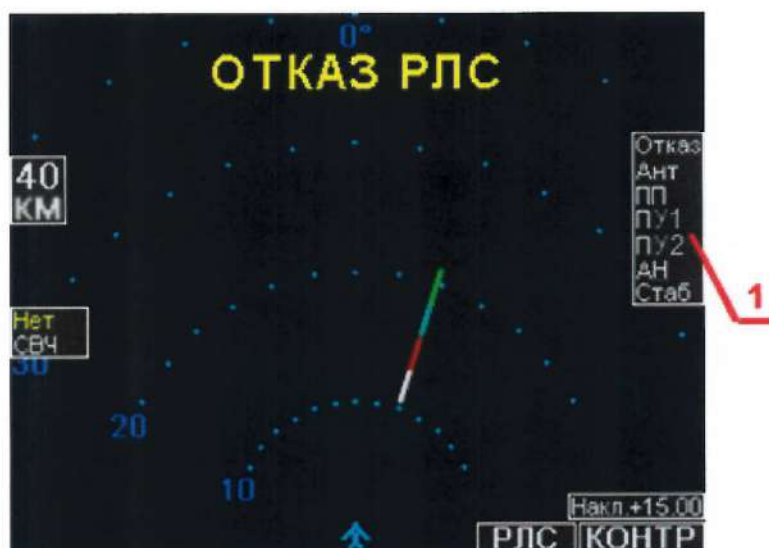
Рисунок 2 – Пример контрольного изображения на экране МФИ при отказе изделия и каналов входной информации в режиме «Контроль»
