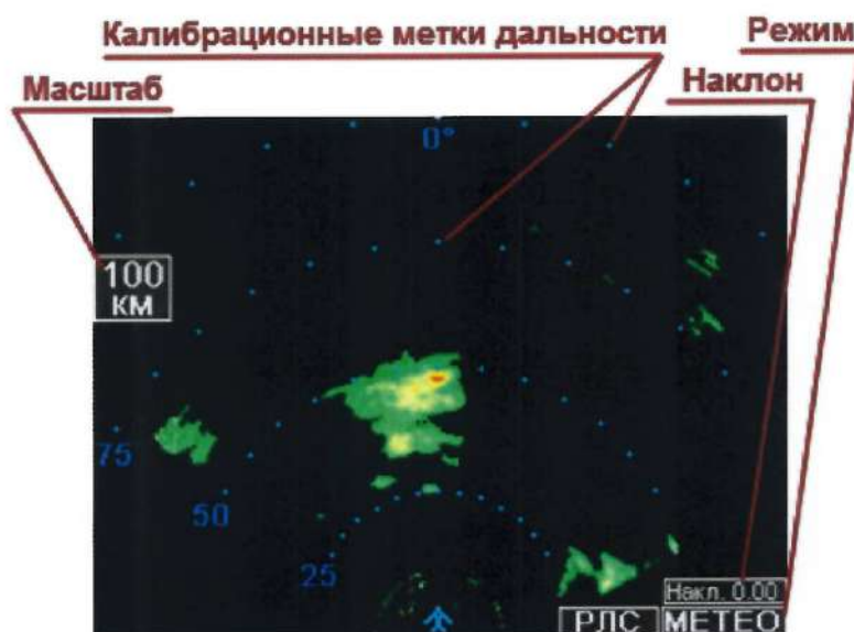
Рисунок 4 – Пример изображения на экране СЭИ, изделие в режиме «Метео»
