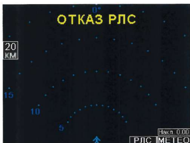
Рисунок 1 – Изображение на экране СЭИ при отказе изделия в режиме «Метео»
