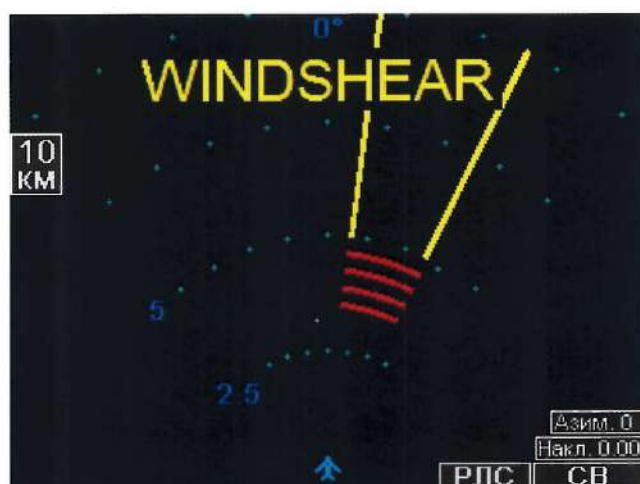
Рисунок 13 – Пример индикации сдвига ветра на экране СЭИ
