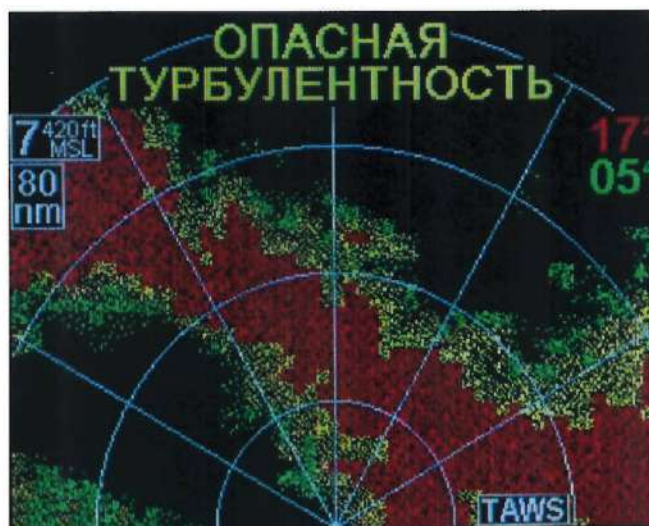
Рисунок 10 – Предупреждение от изделия, работающего в дежурном режиме, об обнаружении опасной турбулентности (на экране СЭИ отображается информация от TAWS)
