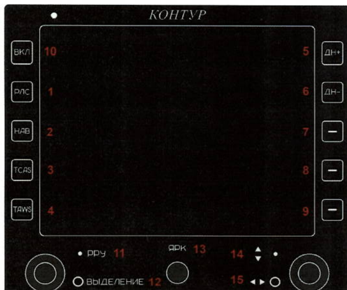
Рисунок 3 – Органы управления МФИ с русскоязычными надписями
