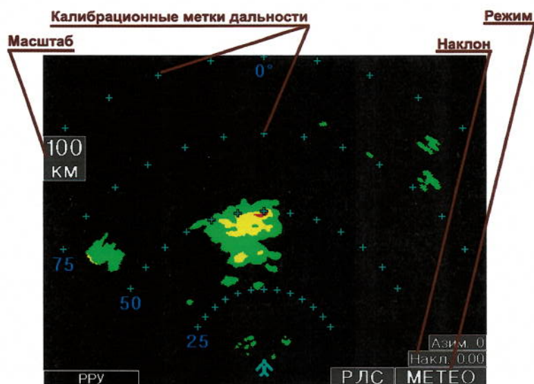
Рисунок 6 – Изображение на экране СЭИ, изделие в режиме «Метео»
