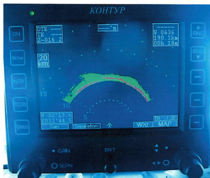
Рис. 30 – «Кольцо высоты» (высота полета 10 км, режим «Земля»)
