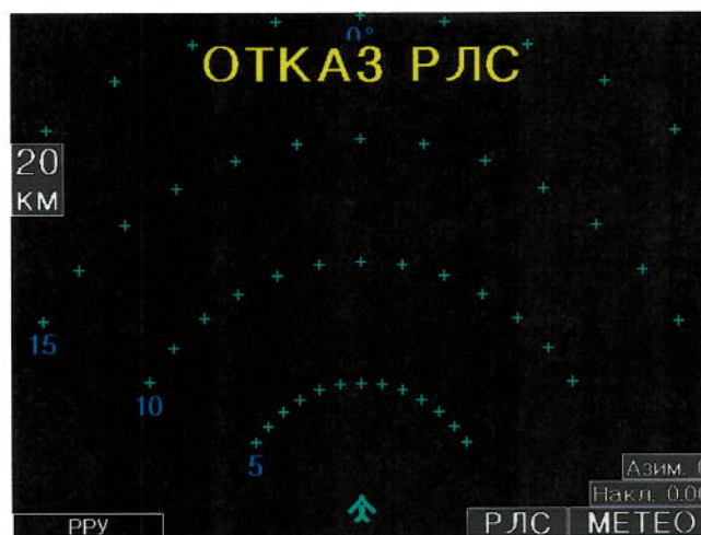
Рисунок 101 – Изображение на экране СЭИ при отказе изделия в режиме «Метео»
