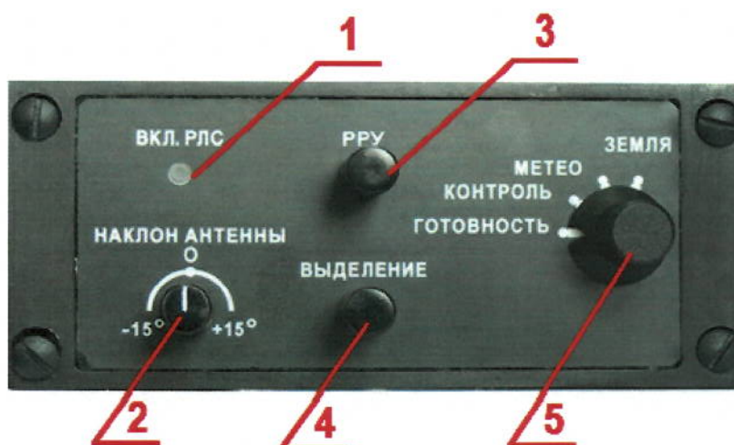
Рисунок 1 – Органы управления пульта управления А813-4903
